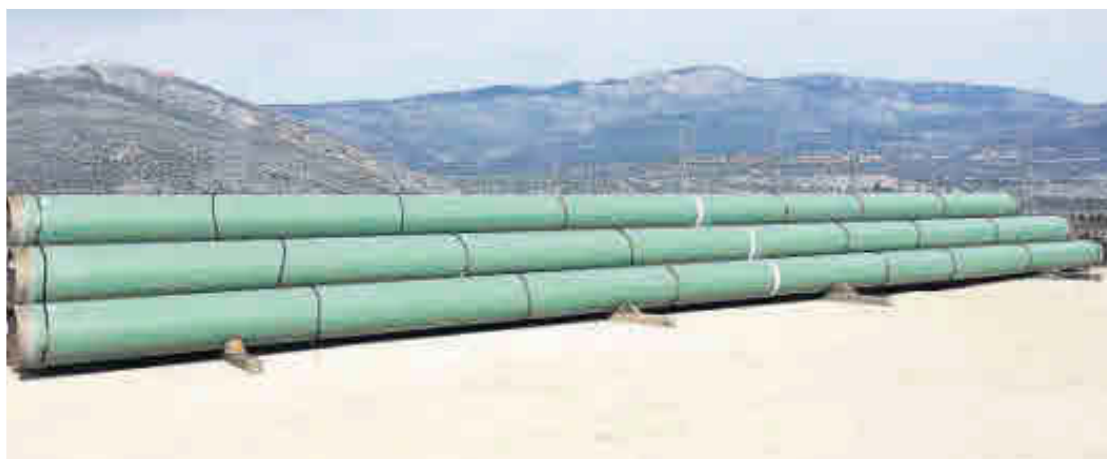
Tubos para el transporte y la conducción de hidrógeno verde fabricados con acero HyMatch, de ArcelorMittal. | ArcelorMittal
